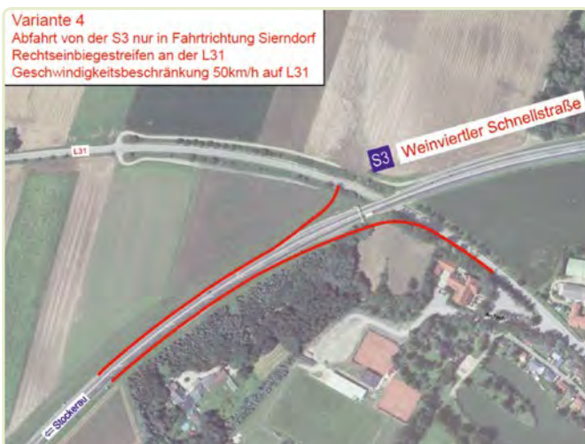
Halbanschlussstelle an die S3.
